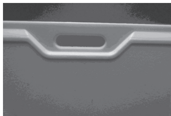
图 10 IC 卡卡套卡孔位置飞边示意图
